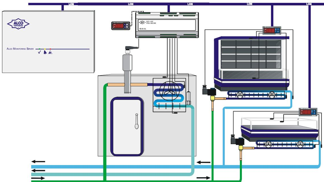
Типичная под-система, показывающая серию EC3-300 в сети LON вместе с EC2 Series Display Case controllers и AMS Monitoring Server
