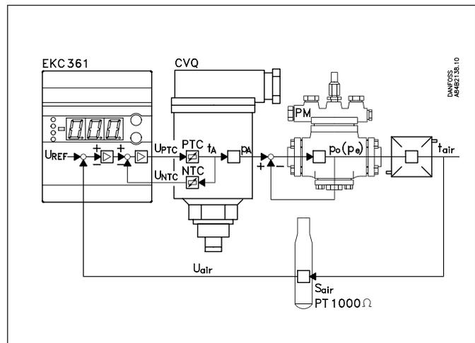
Допустимая температура привода определяет давление испарения
