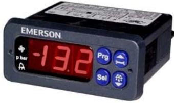
Контроллер EC2-711 предназначен для управления конденсаторами с до 4 вентиляторами. Задачей данного контроллера является поддержание давления конденсации на допустимом минимуме путём включения или отключения вентиляторов.
